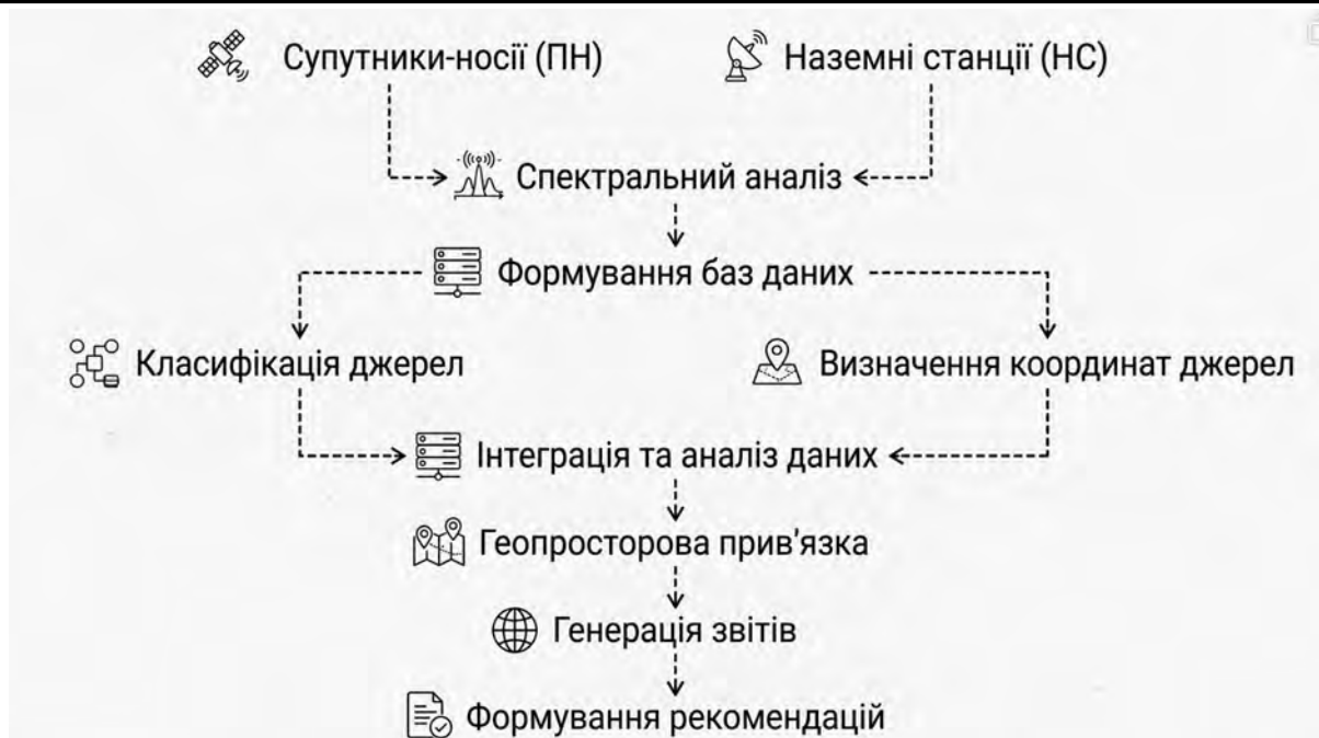
Рис. 1. Алгоритм інтегрованого аналізу супутникових даних для документування змін земної поверхні.
