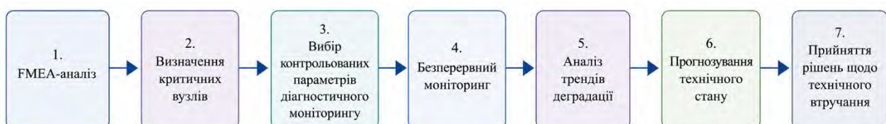
Рисунок 2. Схема формування технічного обслуговування за станом
