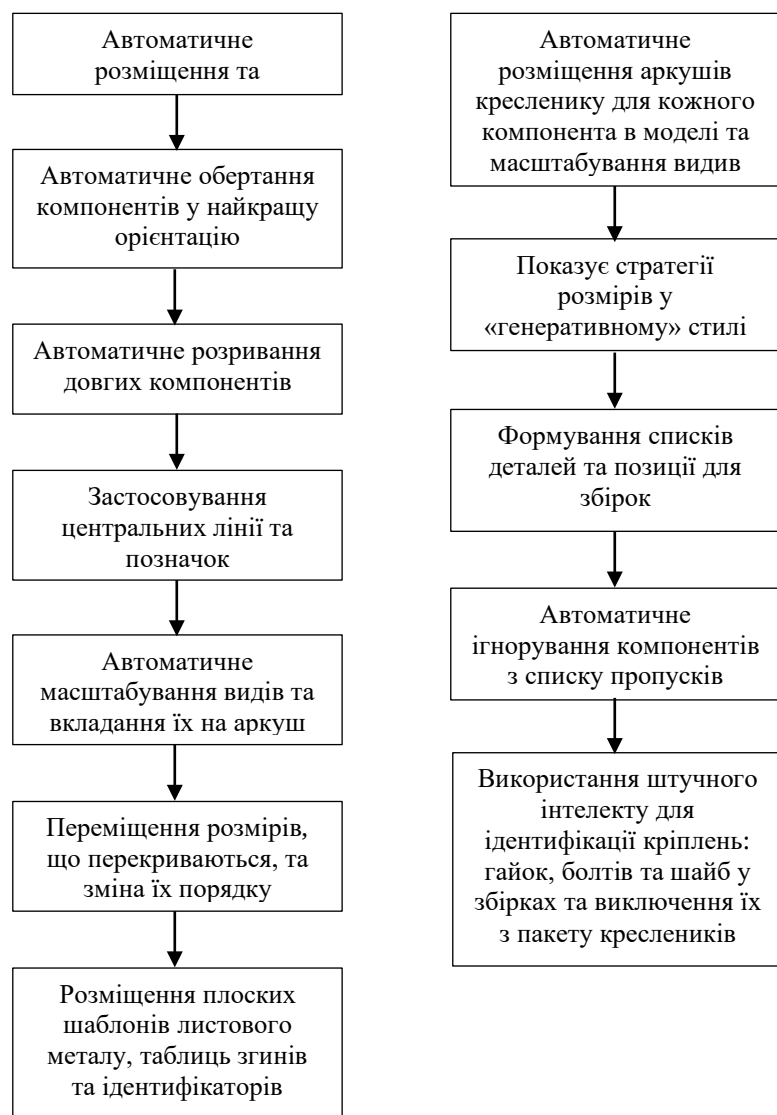
Рисунок 3 Блок схема автоматизованого формування креслеників у Fusion
