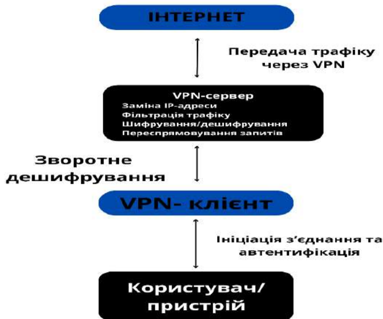
Рис. 1. Схема роботи VPN
