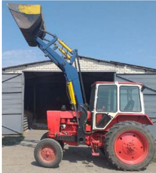
Рис. 1. Фронтальний навантажувач на базі ЮМЗ-6
