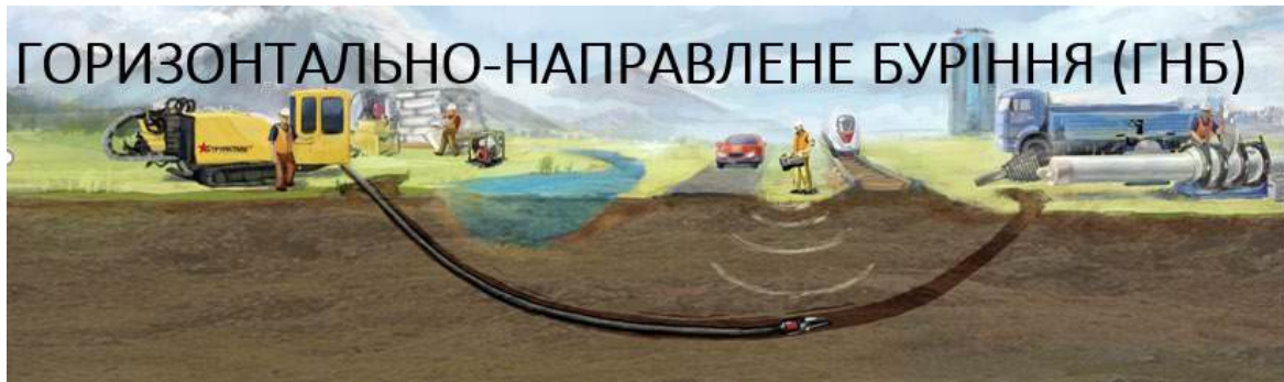
Рис.1. Технологічна схема горизонтально-направленого буріння
