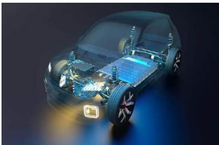
Рис.1 Конструктивне розміщення акумуляторів електромобілів (стандартне інженерне рішення, коли батарейний блок розташований у нижній частині кузова між осями для рівномірного розподілу ваги й захисту елементів)
