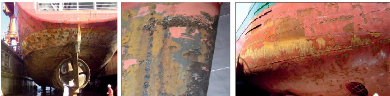
Рисунок 1. Ерозійні та корозійні руйнування викликані кавітацією
