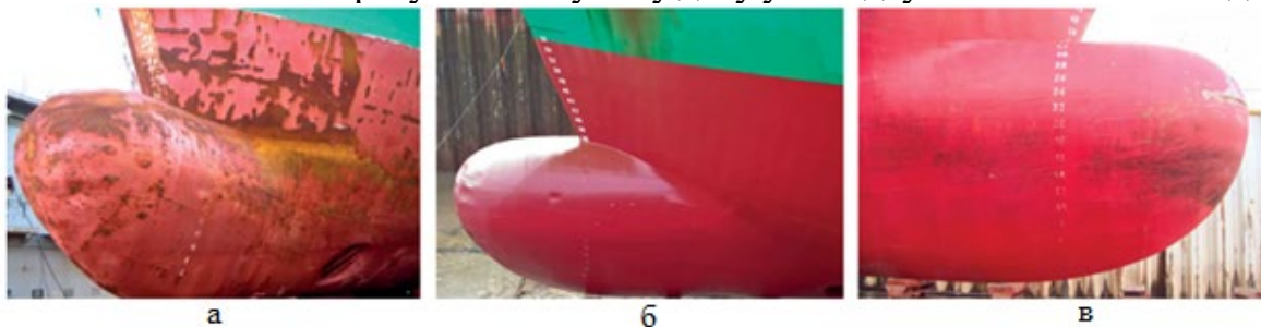
Рисунок 4. Стан корпусу після одного сезону в льоду з використанням звичайного покриття, через п'ять років після того, як корпус було спочатку покрито, але з щорічним ремонтом покриття (а); два роки після застосування Ecospeed (без ремонту) (б); стан корпусу через сім років після застосування Ecospeed, без ремонту (в)
