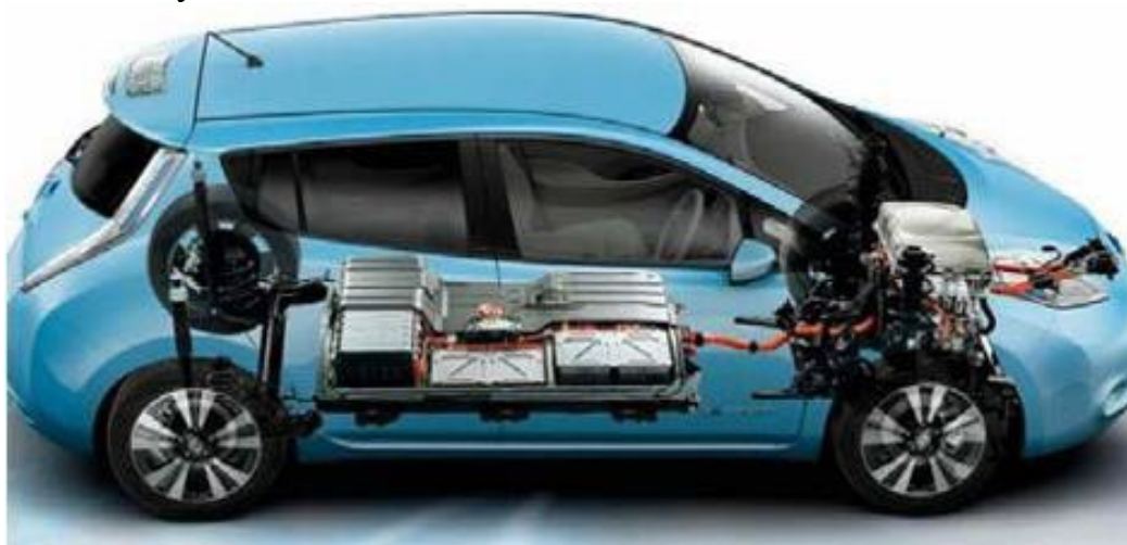
Рисунок 1. Комплект акумуляторів, розташований у частині днища автомобіля
