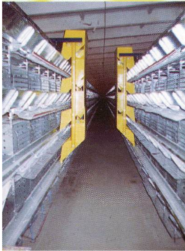
Рис. 1. Трьохярусна кліткова батарея ТБЦБ
