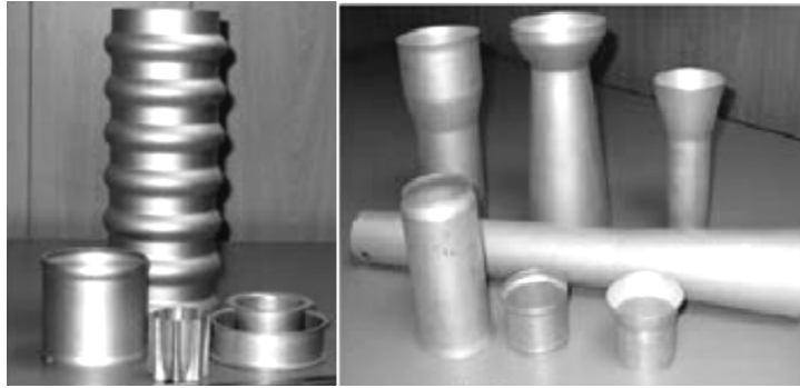
Рисунок 1. Магнітно-імпульсне формоутворення деталей та елементів різного призначення.
