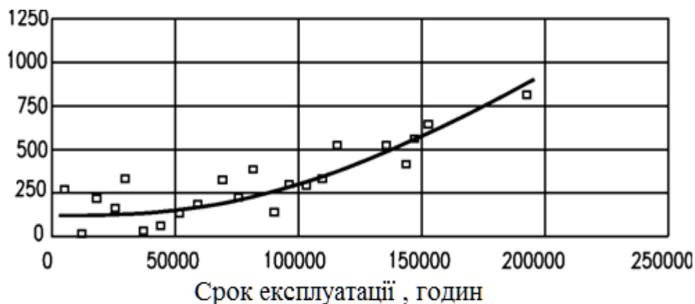
Рис. 4. Зміна часу відновлення устаткування блоку Б при аварійних зупинках по мірі відпрацювання ресурсу
