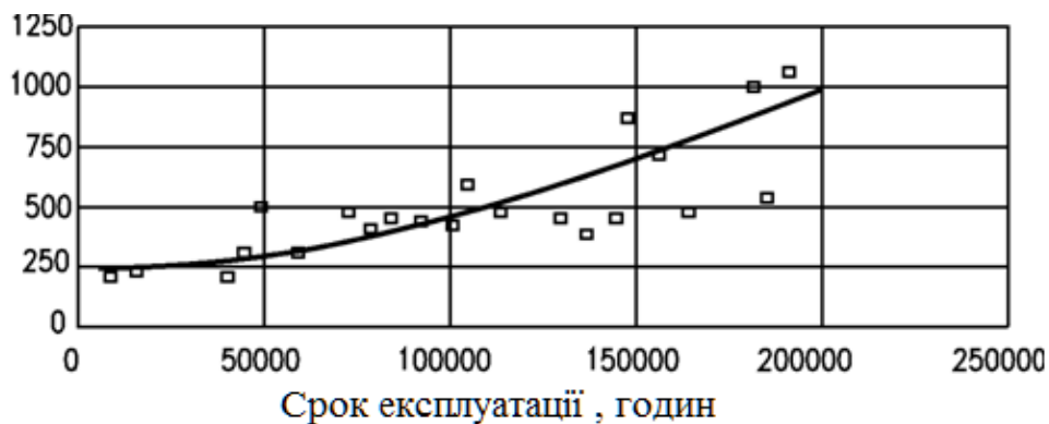
Рис. 3. Зміна часу відновлення устаткування блоку А при аварійних зупинках по мірі відпрацювання ресурсу
